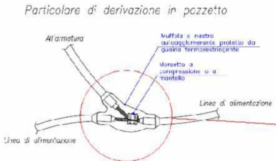
Figura 4: derivazione alimentazione lampade all'interno del pozzetto
